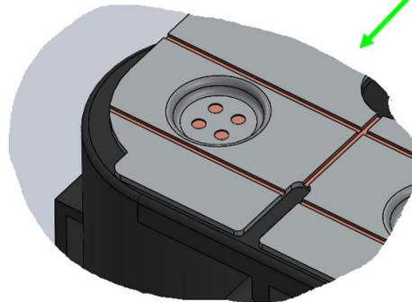
\*\*\*ATTENTION \*\*\* DO NOT CUT TOO DEEP WITH THE DREMEL... THE NICKEL PLATE IS VERY THIN AND YOU MIGHT DAMAGE THE CELLS. THE RIGHT WAY IS TO CUT LIGHTLY THE SURFACE UNTIL YOU SEE THE INSIDE COPPER ALLOY... (THUS IT WILL BE EASIER TO SEPARATE THE WASTE WITH A SMALL ISOLATED FLAT SCREW DRIVER OR COVERED WITH HEAT-SHRINK TO AVOID SPARKS WITH OTHER BATTERIES)
